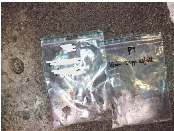
Bilde 7: P1, prøve av asfalt øverste 10 mm
