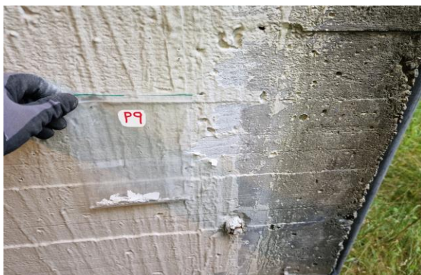
Bilde 5: P9 maling på betong
