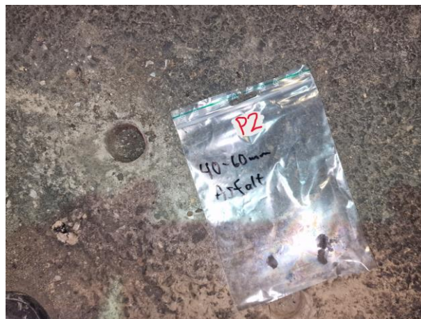
Bilde 6: P2, prøve av asfalt 40-60 mm dypt
