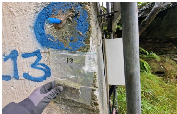
Bilde 6: P8 betong ved inngang til tunnel
